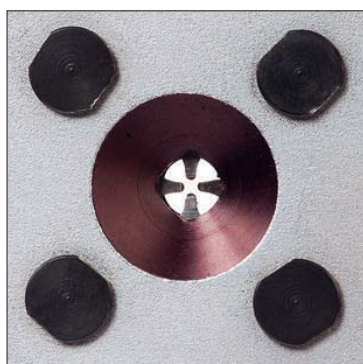
Опрессовочные плашки по стандарту MIL MIL-compliant crimp indents
