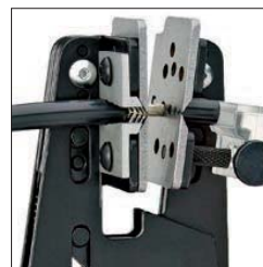
Изоляция удаляется с помощью фасонных ножей Stripping with profile blades
