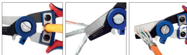
Удаление наружной оболочки с помощью заменяемых фасонных ножей
